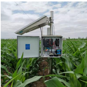
中尺度土壤水分测定仪在大满站野外对比测试（2019.8-2020.12，日值）
