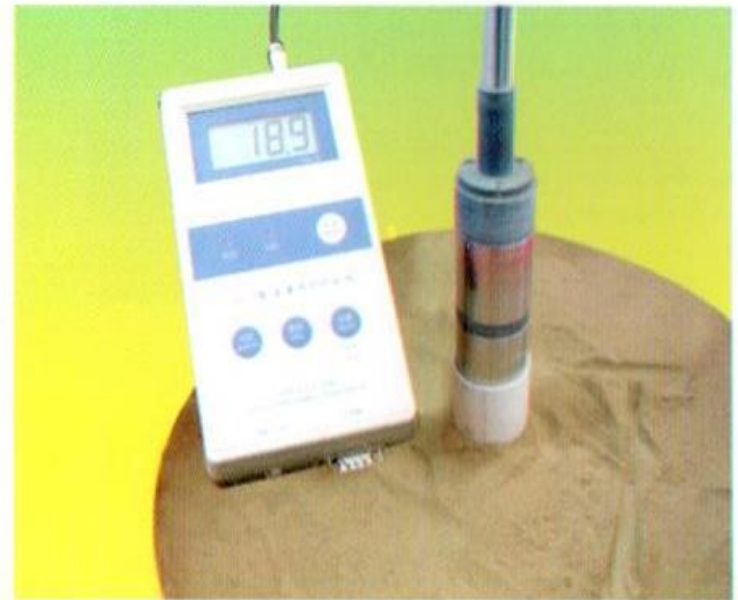
管式土壤水分传感器及仪表进行测试
