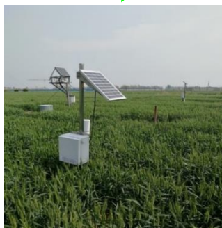
中尺度土壤水分测定仪的野外测试及样地土壤水分采样点分布
