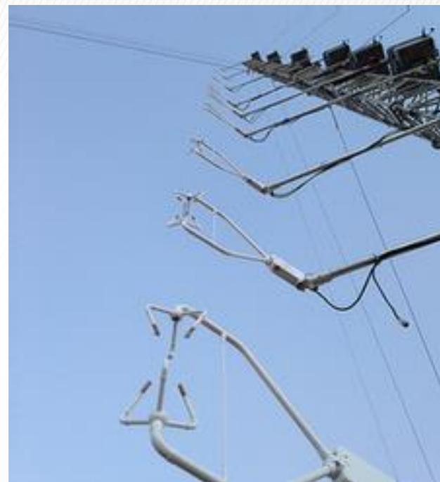
在中国西部的一个CSAT3B传感器网络站点（左）；沿高塔分布的多个CSAT3B测量三维风速和声温的垂直剖面（右）。
